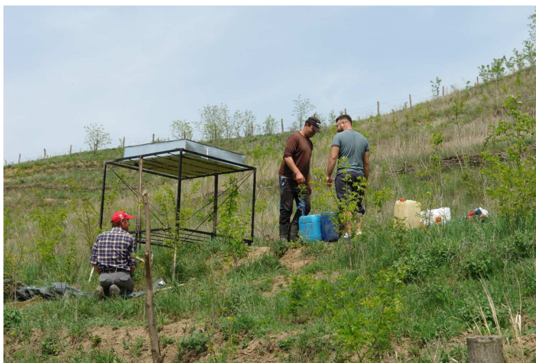
Fig. 8. Instalarea infiltrometrului – Perimetru de ameliorare Frata (jud. Cluj)
